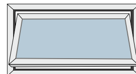
offenen Zustand für äußere Reinigung
